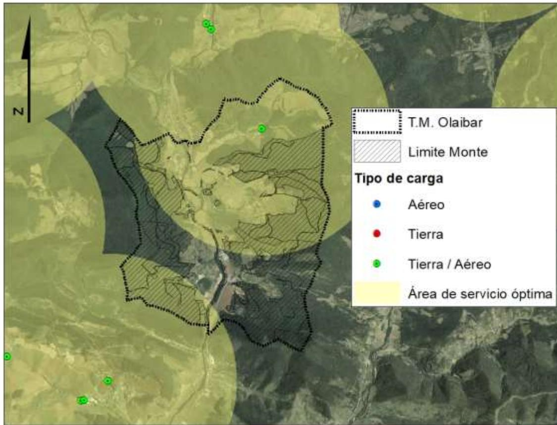
**Figura 43** Localización, tipología y áreas de servicio óptimas de los puntos de agua dentro de la zona de estudio
